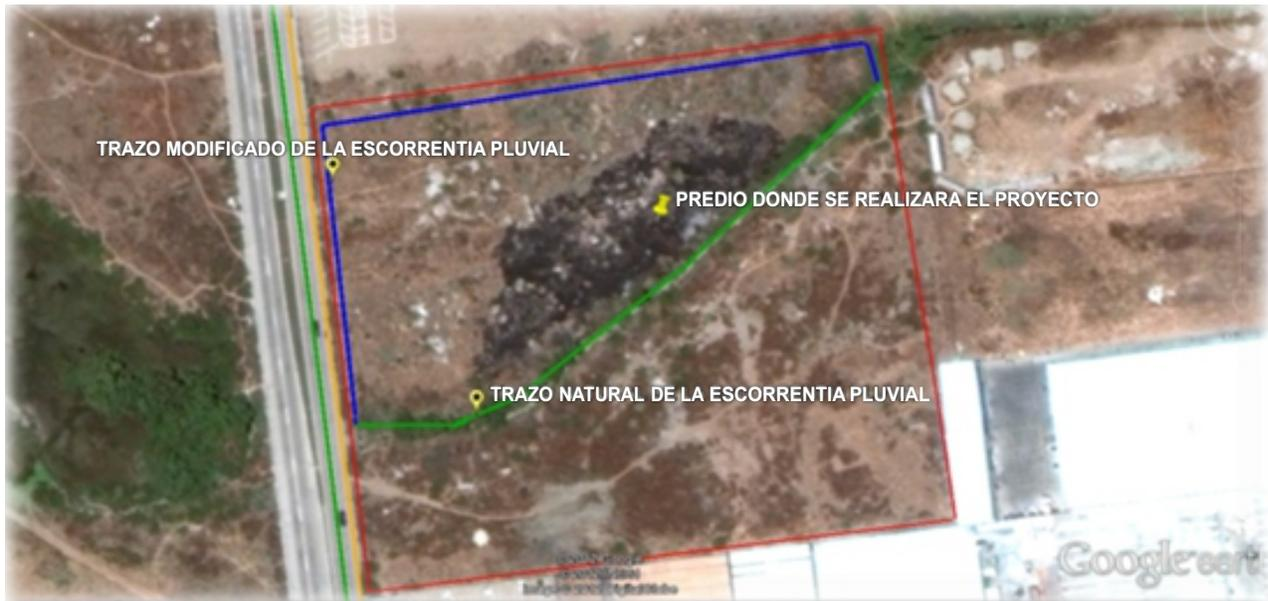
Figura 6. Trazo natural de la escorrentía que alimenta a La Lagunita (en verde) y trayectoria del cauce modificado por el proyecto de instalación de la desalinizadora propuesta (en azul).
